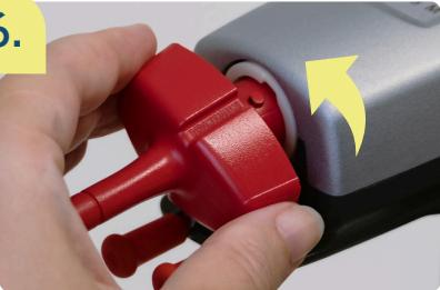
Insérez l'embout buccal (notez la goupille de guidage et la fente de guidage) et tournez dans le sens inverse des aiguilles d'une montre en exerçant une légère pression.
