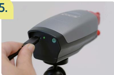
Stecken Sie das Kabel in die USB-C Buchse am hinteren Ende der IMAIR.
