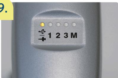
Il LED sinistro si accende (connessione via cavo). Il LED destro (M) è spento (modalità mouse).
