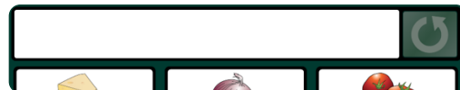
Abb. 6-5 Nachdem eine Nachricht gesprochen wurde, verschwindet sie aus dem Nachrichtenfenster. Mit dem Wiederholen-Button wird die Nachricht erneut eingeblendet und abgespielt. Der Inhalt des Nachrichtenfensters wird bis zur nächsten Nachricht zwischengespeichert.
